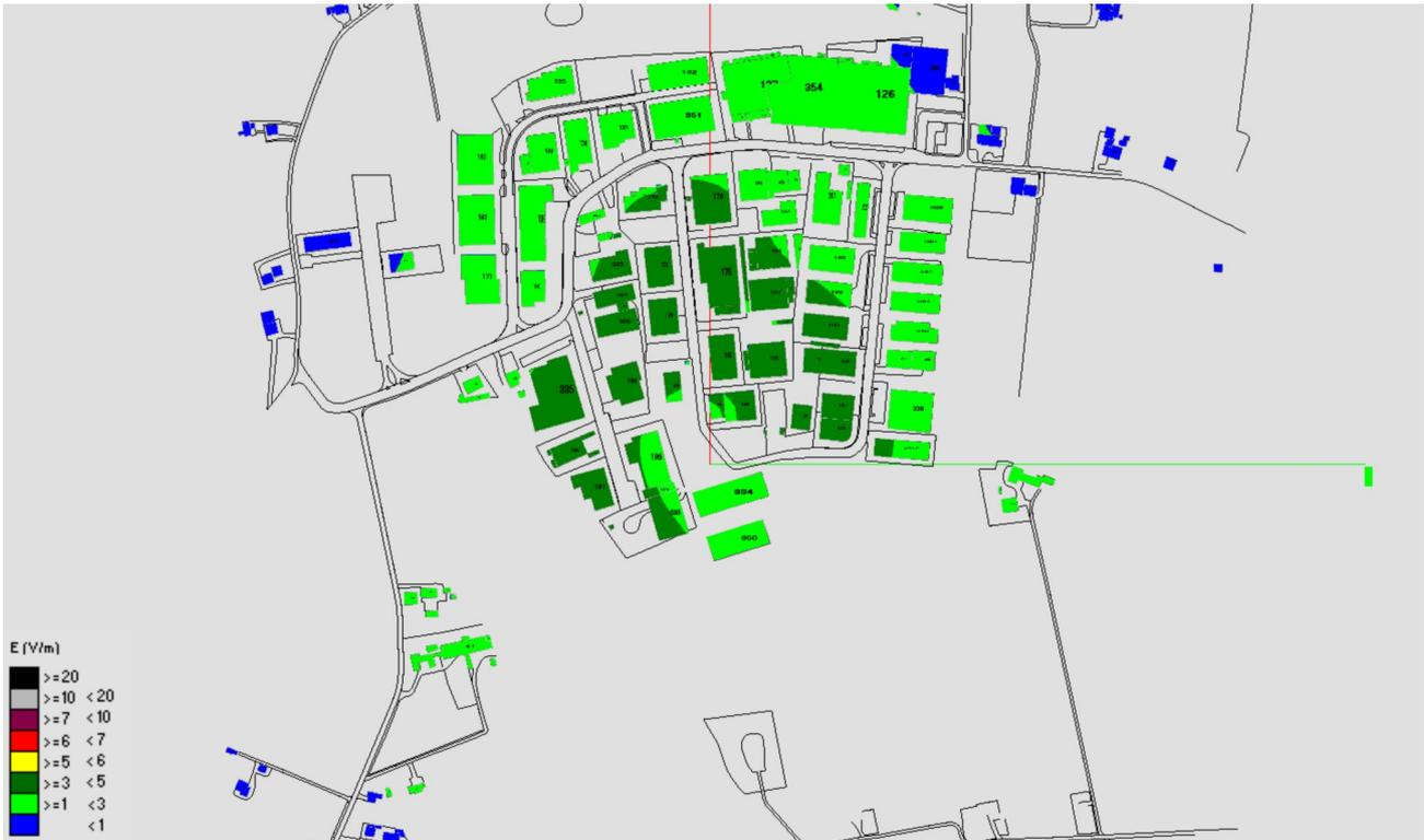
Fig. 2 Impatto Elettromagnetico – zona ZI Via A. Volta – Vista dall'alto
